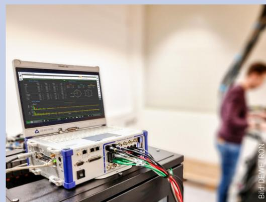
Der portable Power Analyzer DEWE3-A4 garantiert hochpräzise Messresultate.
