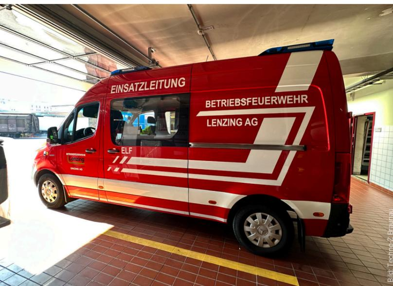
Ein dieselbetriebenes Einsatzleitfahrzeug der Betriebsfeuerwehr der Lenzing AG wurde im Projekt E-ELF mit Sensorik aufgerüstet, um Daten der elektrischen Verbraucher zu erheben.
