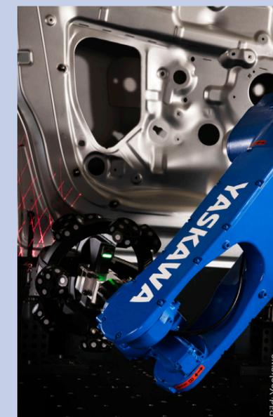
Geführt von einem Motoman GP12 scannt der Messkopf das zu prüfende Bauteil detailliert ab, wobei insgesamt drei unterschiedliche Laser zum Einsatz kommen.
