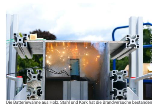
Die Batteriewanne aus Holz, Stahl und Kork hat die Brandversuche bestanden.
